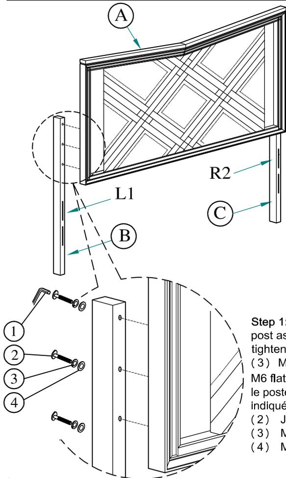
**Step 1:** Attach the (B) extension post as shown in the drawing and tighten with (2) JCBC 60mm, (3) M6 spring washer & (4) M6 flat washer. / Étape 1: Attachez le poste d'extension (B) comme indiqué dans le dessin et serrez avec (2) JCBC 60mm des boulons, (3) M6 rondelle d'arrêt et (4) M6 rondelle plate.
